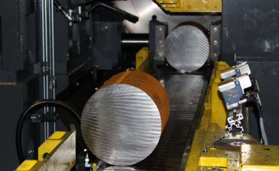
В январе 2019 г. в компании "Vítkovice Cylinders из группы Cylinders Holding была установлена ультрасовременная разделительная линия Linsinger. Устройство существенно увеличивает емкость заготовок и повышает эффективность производственного узла экструзии бесшовных баллонов под давлением. Устройство позволяет изготавливать стальные заготовки диаметром от 150 до 240 мм.
